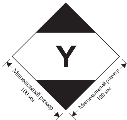
Маркировочный знак для упаковок, содержащих ограниченные количества, соответствующие положениям главы 4 части 3 Технических инструкций ИКАО
