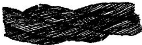
Рисунок 1. Обрывы и смещения проволок каната крестовой свивки.
